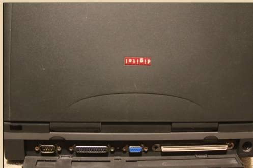
Рис. 2. Задняя часть ноутбука имеет COM/LPT/VGA/PS2-порты и порт-расширение для док-станции
