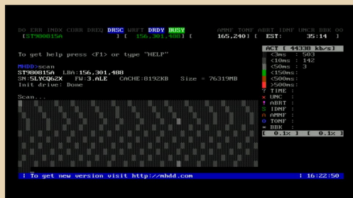
Рис. 19. MHDD на ноутбуке с новым диском показывает среднюю скорость чтения в 40 МБ/с
